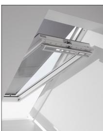
Marchisetta ad azionamento manuale senza guide di scorrimento laterali. La marchisetta viene inserita nel cassone della finestra per tetti e, quando è chiusa, il suo tessuto resta così protetto dagli agenti atmosferici. La finestra viene ruotata nella posizione di pulizia e la marchisetta agganciata nei ganci di fissaggio posti sul telaio inferiore della finestra. Chiudendo la finestra viene estratta la marchisetta. Il montaggio può avvenire dall'interno o dall'esterno.
