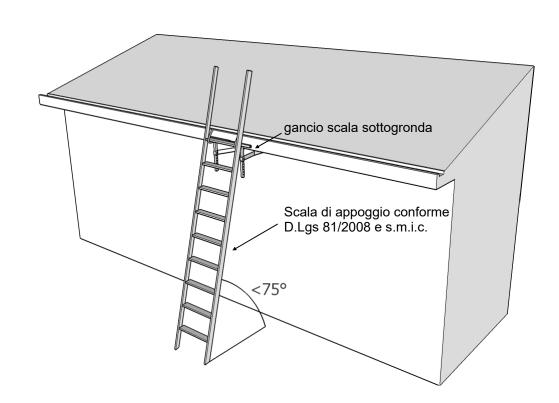
**75°**: Angolo massimo per le scale d'appoggio. Le scale aventi angolo di inclinazione maggiore sono comparate alle scale verticali.
