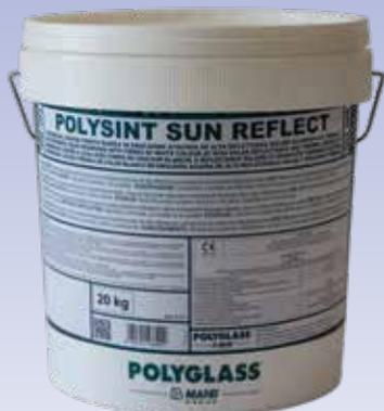
**POLYSINT SUN REFLECT** è una membrana liquida acrilica fibrata in emulsione acquosa di colore bianco, ad alta riflettanza solare (83%) ed emissività termica (91%) con indice di riflessione solare (SRI) 105 per la protezione di membrane impermeabili bituminose e superfici in calcestruzzo.
